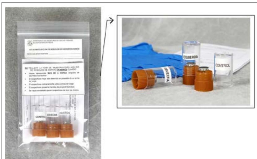
Figura 26 Kit para la recolección de muestras mediante cinta adhesiva de carbón para análisis de residuos de disparo en manos mediante SEM-EDX.
