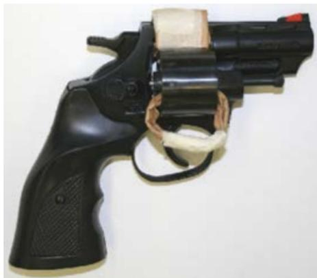
Figura 22A. Forma de embalar un revólver, cilindro abierto y obstruido con un cartón o papel
