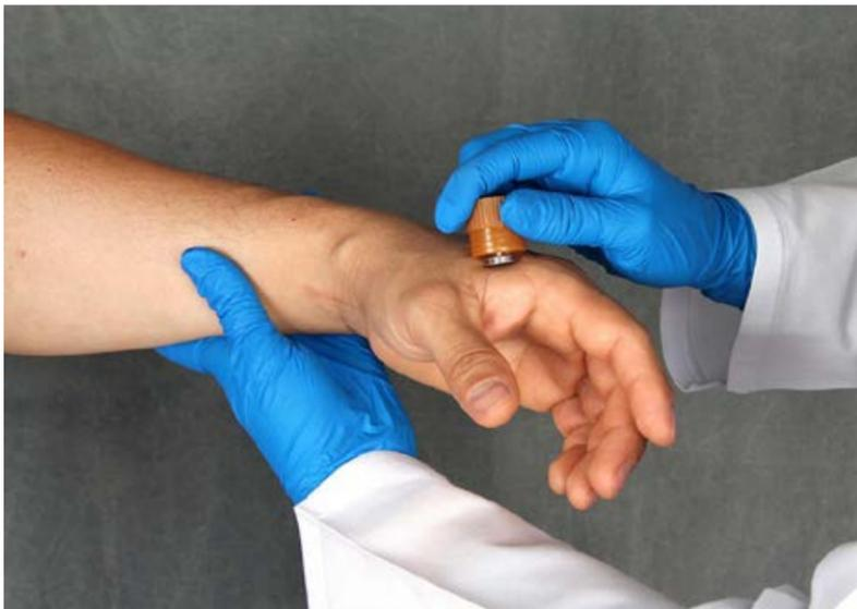
Figura 27. Recolección de muestras mediante cinta adhesiva de carbón para análisis de residuos de disparo en manos mediante SEM-EDX.
