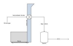
Precalentar el agua de aportación mediante un economizador (en el caso de que el equipo de combustión sea una caldera). Esta solución puede aumentar el rendimiento de la caldera un 4 % (el ahorro energético conseguido depende, entre otros factores, de las exigencias del sistema local, la calidad de los gases de combustión, etc.)
