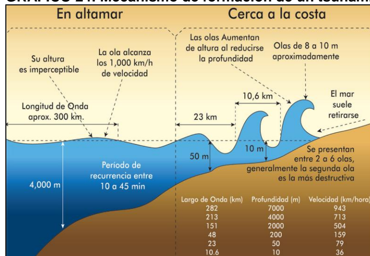
GRÁFICO 24: Mecanismo de formación de un tsunami
