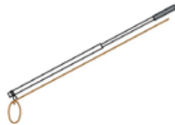
Figura VII.3. Esquema de un lado para captura viva de reptiles
